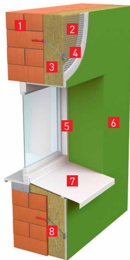
9. Конструктивное решение верхнего и нижнего откосов оконного проёма
