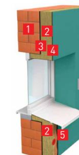
1 — наружная стена; 2 — плиты теплоизоляционные (ФАСАД БАТТС/ФАСАД БАТТС Д/ФАСАД ЛАМЕЛЛА); 3 — клей ROCKglue и ROCKmortar; 4 — усиленная армирующая сетка; 5 — армирующий слой; 6 — декоративная штукатурка ROCKdecor.
