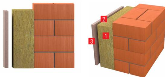
1 — утеплитель; 2 — вентилируемая воздушная прослойка; 3 — фасадная плита из плотного материала.
